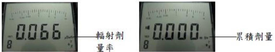
5. 偵測時嗶嗶聲輔助輻射強度感測，強度愈強嗶聲響愈密集。
