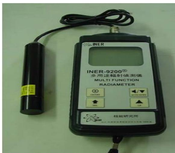
圖 3：外接式 RM-18  $\gamma$  輻射偵檢頭
