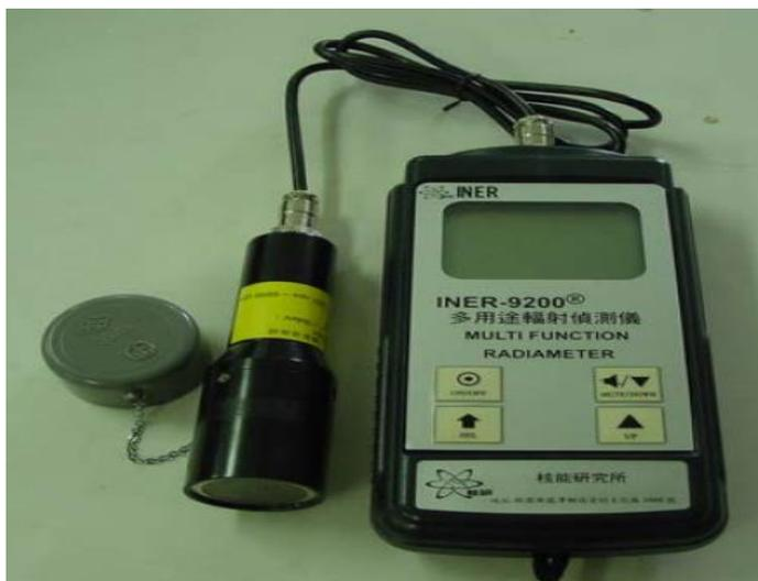
圖 2：外接式 RM-17  $\alpha$   $\beta$   $\gamma$  輻射偵檢頭
