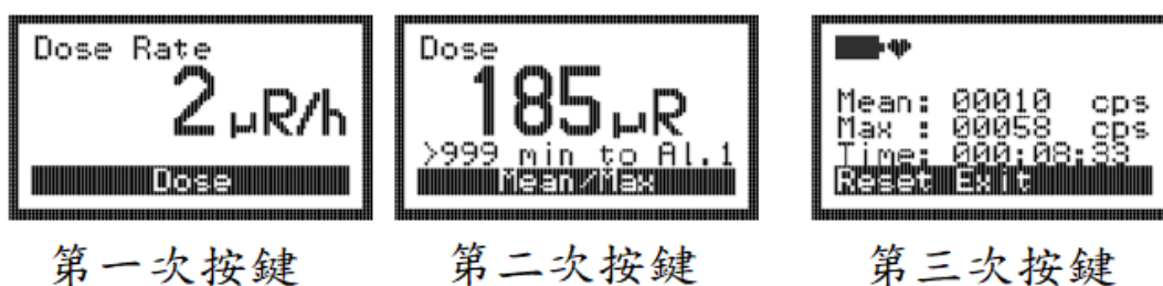
圖 5：計數率模式切換讀值顯示畫面
