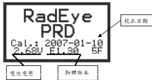
圖 2：RadEye PRD 開機初始畫面
